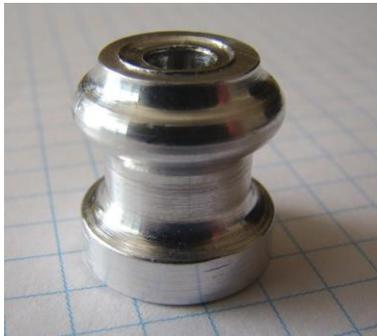
Die kugelförmig ausgebildete Messfläche bietet auch bei unvermeidlich schräg gesetzten Bohrlöchern immer noch eine exakt definierte Messfläche.
